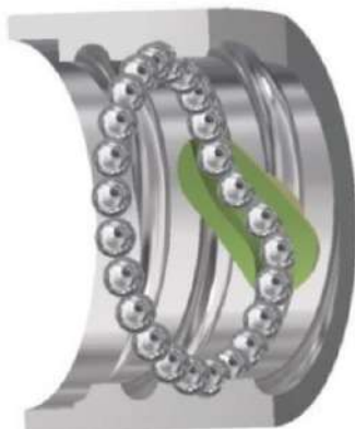
Darstellung Umlenkung bei Innenzirkulation Diagram of internal circulation return path
