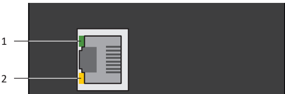
Ilustr. 68: Diody sygnalizacji stanu połączenia sieciowego serwisowego
