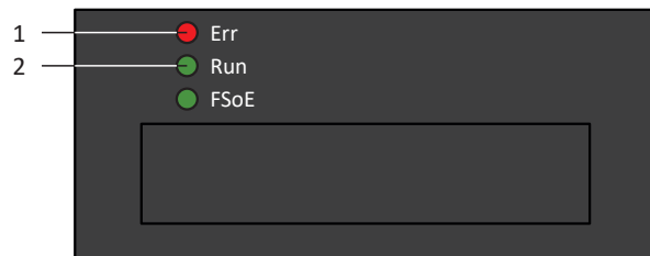
Ilustr. 60: Diody sygnalizujące stan EtherCAT
