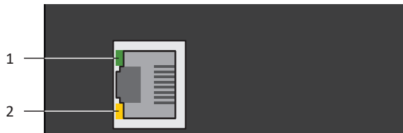
Ilustr. 65: Diody sygnalizacji stanu połączenia sieciowego serwisowego
