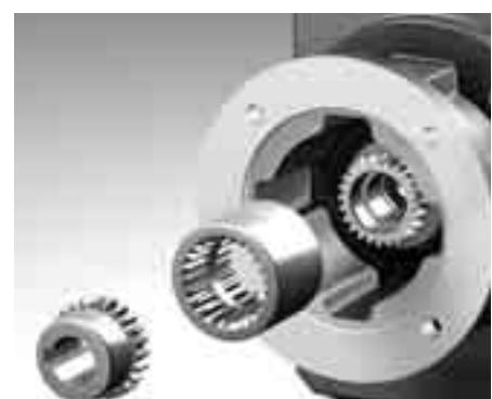
**MQ** – Motoradapter mit Bogenzahnkupplung (flexible Wellenverbindung) für Motoren mit Passfeder, optional auch mit spielfreier Steckkupplung zum Anbau von Motoren mit glatter Welle
