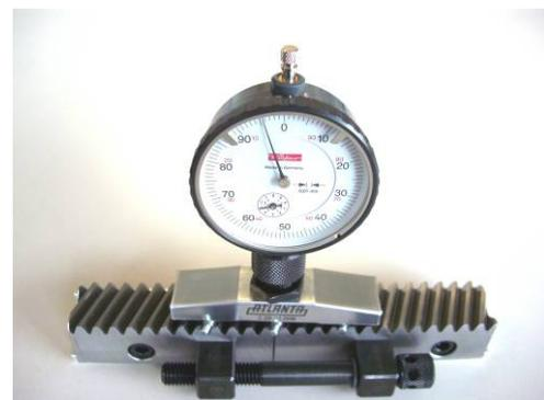
7. Mit einem Sechskantschlüssel kann die Nachstellschraube an der Verschiebeeinheit so verstellt werden, dass die noch nicht fest verschraubte Zahnstange, nach links oder
