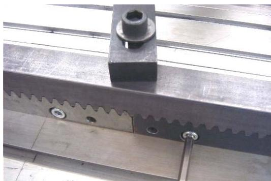
3. Die Innensechskantschrauben der zweiten Zahnstange so anziehen, dass ein Ausrichten noch möglich ist. Danach Gegenstück entfernen.
